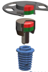
Abbildung 2: Titanmagnetics® X-Line Prinzip im Schnitt
